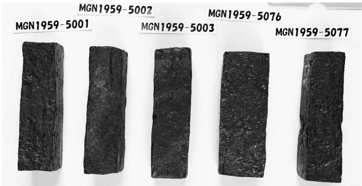
③チキリ鉄（MGN1959-5001～5003、5076、5077）のA面の左側面
