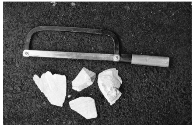
写真4 滑石を切るために使った竹切鋸
