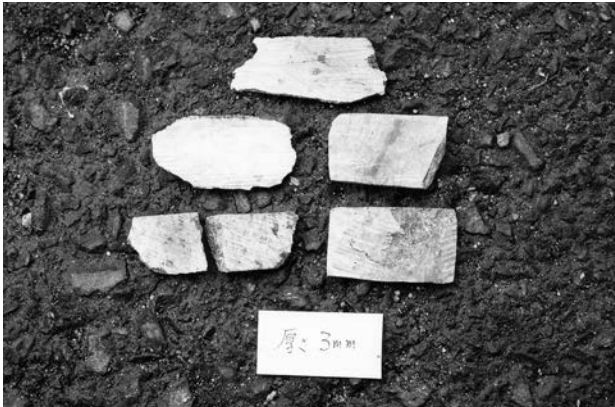
写真9 加熱前の状態（3mm）
