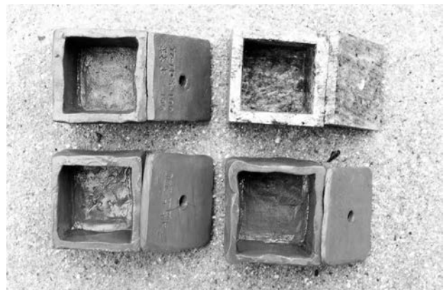
写真15 実験容器（右上は滑石、その他は素焼き）
