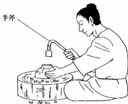
3. 型打ち 荒木地の外側を手斧[ちょうな]で削り、成形する(この工程を「まるめる」と呼ぶ)
