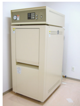
脱塩処理装置
