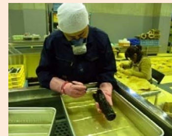
アルコールでの洗浄作業
